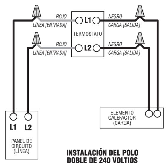
**NOTA DEL DIAGRAMA DEL CABLEADO:**
